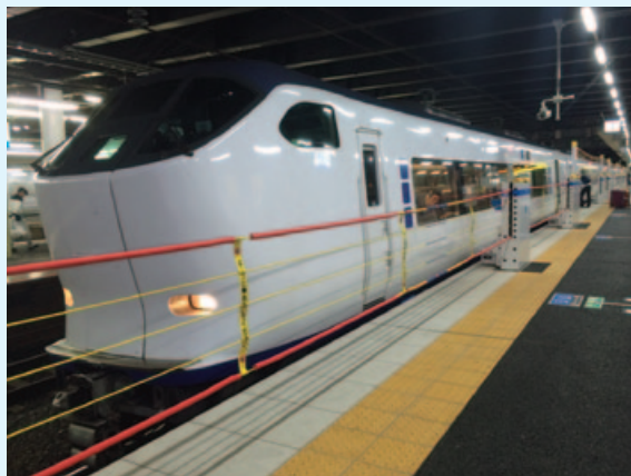
高槻駅昇降式ホーム柵
